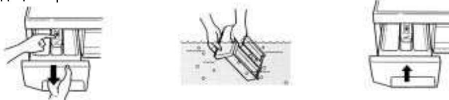
\*Закончив мытье отсека, вставьте его назад и включите машину в режиме полоскания без вещей.
